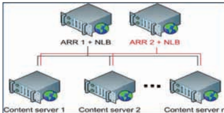
Rajah 30: Konsep Load Balance Ke Atas Sistem Aplikasi Utama
